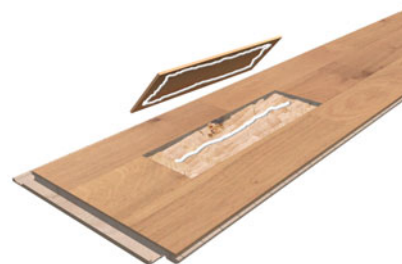
Udvælg og tilpas en erstatningsstav. Fyld hullet med polyesterspartelmasse, og tryk staven ned.
